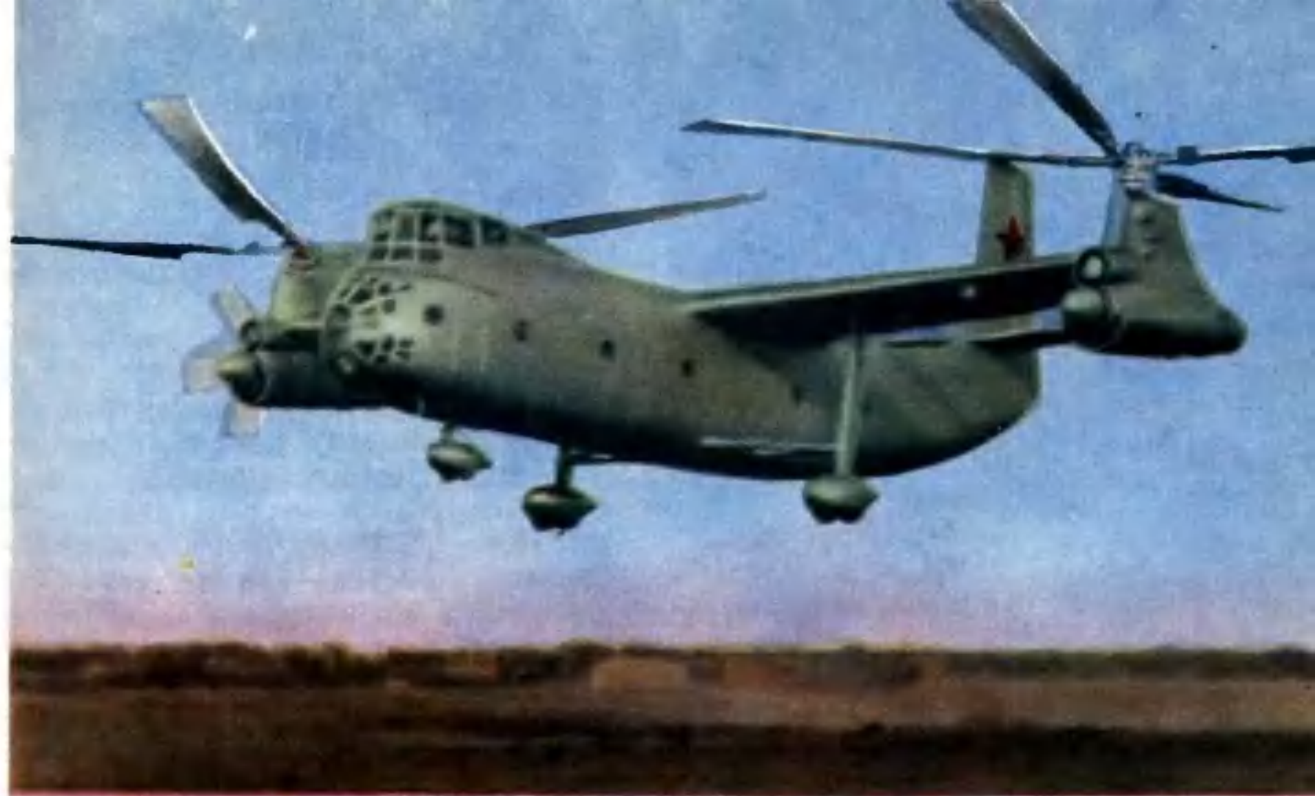
Винтокрыл КА-22 с двумя турбореактивными двигателями мощностью по 5700 л. с. каждый. На нем было установлено восемь мировых рекордов. Один из них — рекорд скорости: 336 км в час. Силач КА-22 сумел поднять 16 448 кг.
